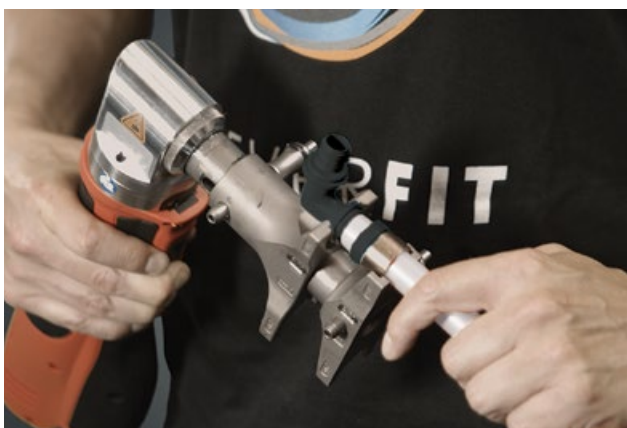
Tragerea inelului peste fitting
