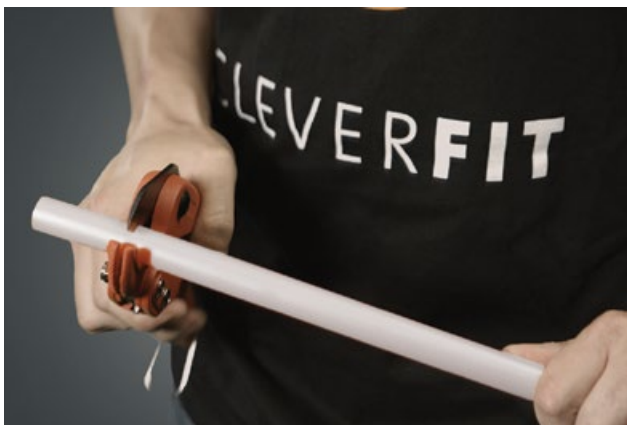
Tăierea corectă a conductei cu o foarfecă
