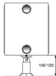
Car, pour le type 33, la vanne de raccordement est placée de façon excentrique dans le radiateur, la mesure b change en 126 mm pour une raccordement gauche.
