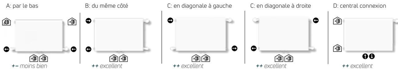
Le radiateur peut-être raccordé comme un radiateur compact en enlevant le corps de vanne thermostatizable.
