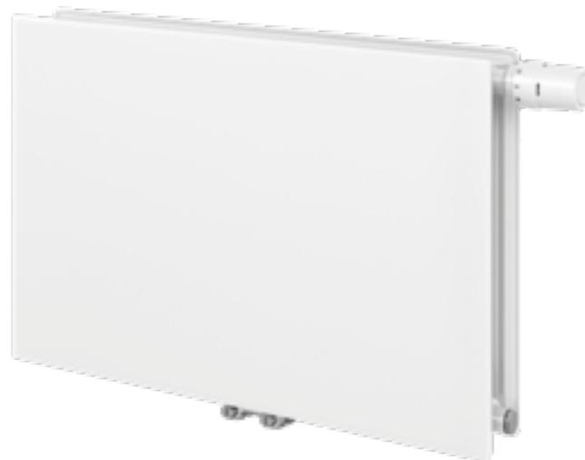
Le T6 3010 PLAN TERTIAIRE convient particulièrement aux environnements recevant du public où le design et l'hygiène sont primordiales. Dépourvu d'ailettes et doté du raccordement central, le radiateur acier panneau habillé plan est équipé d'un insert thermostatique M30x1,5.
