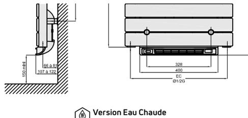
\* Les entraxes et systèmes de fixation sur les modèles Speed'Air ne sont pas les mêmes que sur les modèles standard (cf.notice).
