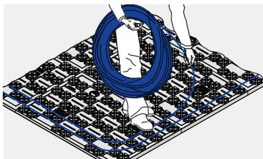
La courbure naturelle d'enroulement du Cosytube facilitera la mise en place de celui-ci à chaque changement de direction.
