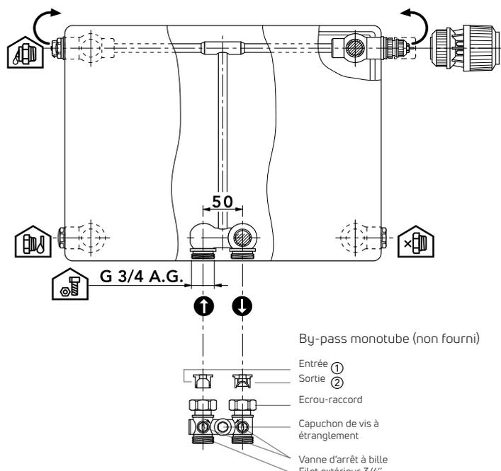
Le radiateur est livré avec un capuchon de protection monté. Une fois le capuchon de protection démonté, les têtes thermostatiques des modèles «TRVFIN2» et «TRVFIN3» de la marque FINIMETAL, modèles «UNI» et «PINOX H» de la marque OVENTROP, modèles «SENSO» et «SENSITY» de la marque COMAP, modèle «RAW K» de la marque DANFOSS, modèle «K» de la marque HEIMEIER peuvent être directement montées sur le robinet du radiateur.
