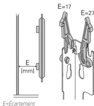
Élément encliqueté avec dispositif de sécurité intégré permettant d'enlever et de déplacer le radiateur en toute sécurité.
