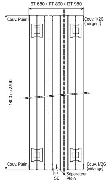
L'obturateur est monté d'usine pour cette fabrication spéciale en raccordement central.
