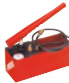
Pour vérifier l'étanchéité des réseaux, le système doit être testé en pression à 6 bar durant 2 heures.
