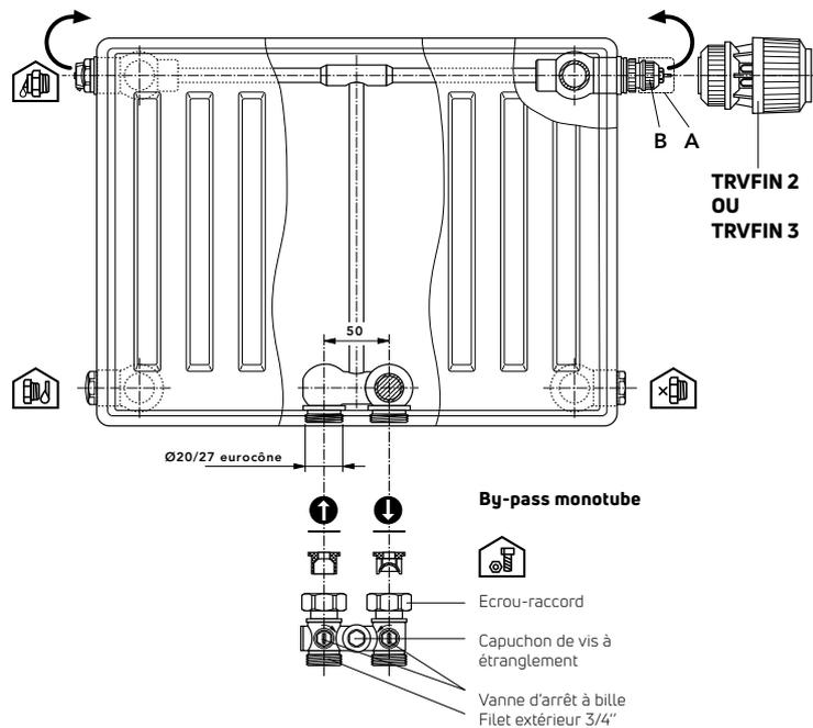
Le radiateur est livré avec un capuchon de protection monté. Une fois le capuchon de protection démonté, les têtes thermostatiques des modèles «**TRVFIN2**» et «**TRVFIN3**» de la marque **FINIMETAL**, modèles «**UNI**» et «**PINOX H**» de la marque **OVENTROP**, modèles «**SENSO**» et «**SENSITY**» de la marque **COMAP**, modèle «**RAW K**» de la marque **DANFOSS**, modèle «**K**» de la marque **HEIMEIER** peuvent être directement montées sur le robinet du radiateur.
