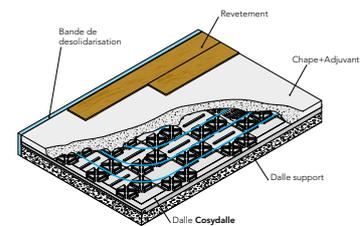
La résistance thermique au-dessus du tube ne dépassera pas  $0,15 \text{ m}^2 \cdot \text{K/W}$ . Quelque soit le type de revêtement de sol sélectionné, il est important de respecter le temps de séchage de la dalle d'enrobage, la 1ère mise en température de la dalle, l'arrêt éventuel du chauffage durant la pose et la conformité du matériel avec la pose d'un plancher chauffant auprès du fabricant.
