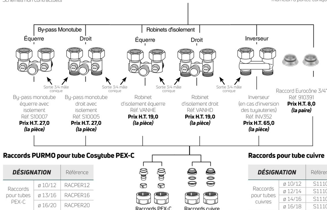
Les références S10007, S10005, S10021, S10020 et INV352 doivent être installées directement sur les orifices de raccordement du radiateur T6 3010 PLAN et T6 3010 DECO. Le mamelon à portée conique n'est dans ce cas pas utilisé.
