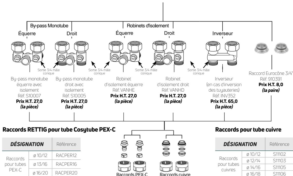
Les références S10007, S10005, S10021, S10020 et INV352 doivent être installées directement sur les orifices de raccordement du radiateur T6 3010 PLAN et T6 3010 DECO. Le mamelon à portée conique n'est dans ce cas pas utilisé.
