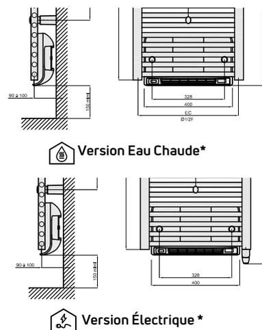
\* Les entraxes et systèmes de fixation sur les modèles Speed'Air ne sont pas les mêmes que sur les modèles standard (cf.notice).
