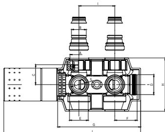
Deux nouveaux robinets à entraxe 50 mm avec tête thermostatique adaptées à tous nos radiateurs verticaux avec raccordement central 50 mm (installation bitude).
