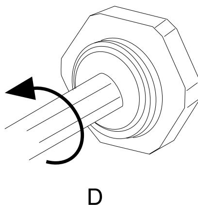
Le préréglage est maintenant défini et ne changera pas, même après l'ouverture et la fermeture à l'aide de la clé Allen.
