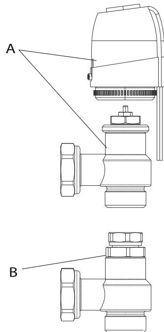
**A** Vanne automatique avec tête thermoélectrique**B** Raccord de réglage/d'équilibrage**C** Raccord coudé à 90° AZ5H00AI020300NO
