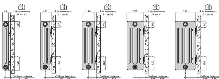
2 colonnes 3 colonnes 4 colonnes 5 colonnes 6 colonnes
