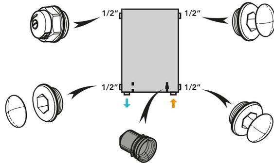
Set de 1 bouchon purgeur à jet orientable blanc, 3 bouchons pleins blancs et 1 obturateur + 1 joint torique
