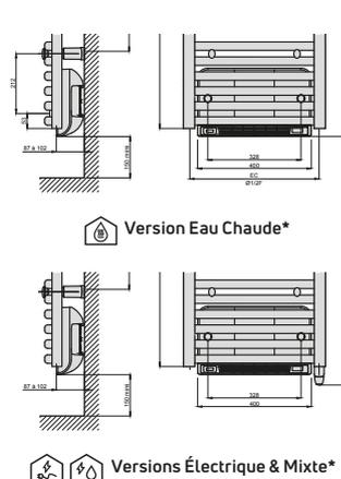
\* Les entraxes et systèmes de fixation sur les modèles Speed'Air ne sont pas les mêmes que sur les modèles standard (cf.notice).
