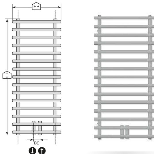
Si le radiateur est raccordé à gauche ou à droite ( sans le raccordement central), la puissance est légèrement moindre en raison de l'absence de circulation d'eau dans les 2 tubes inférieurs.
