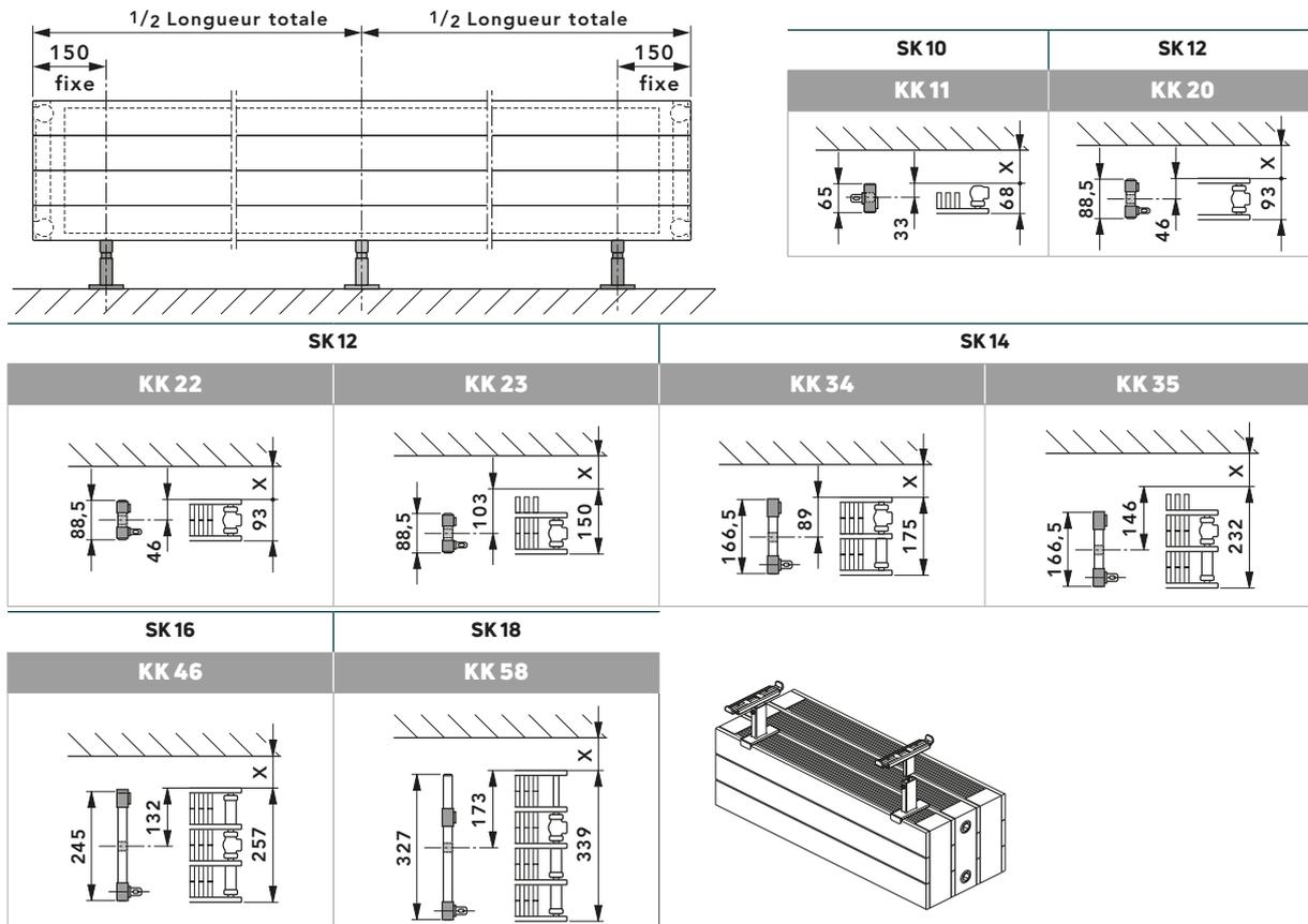
X : Distance choisie entre le mur et l'arrière du radiateur
