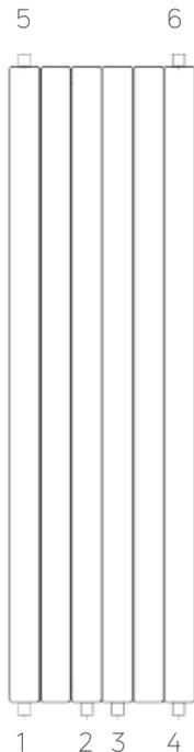
**Important :** Afin de garantir une bonne circulation du fluide, le raccordement sur le collecteur (aller/retour) doit s'effectuer du côté identifié par l'autocollant rouge.
