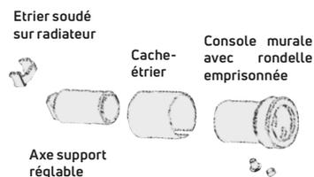
La rondelle pivote à 360° pour un ajustement parfait de la console
