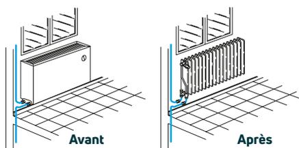
Ces versions ont pour caractéristique commune de faciliter au maximum le remplacement des convecteurs en évitant les modifications de tuyauteries. Les caractéristiques de pertes de charge des Lamella R2 et R3 sont très proches de celles des convecteurs eau chaude présents sur le marché français. L'assemblage du robinet sur le radiateur se fait à l'aide de 2 douilles de type Banjo spécialement étudiées pour le Lamella.
