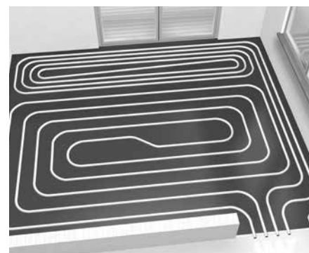
Abb. 4: schneckenförmige Verlegung mit separater Randzone
